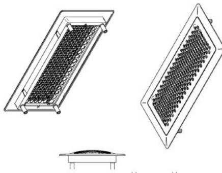
Griglie con estetica speciale realizzate in metallo (laser), e fissate tramite magneti
